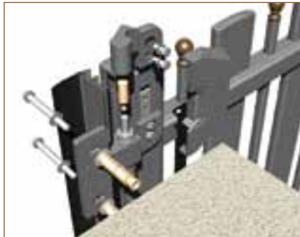
Détail de la paumelle 3 branches en fixation sur maçonnerie
