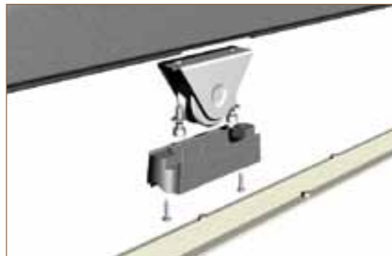
Détail du rail et de l'ensemble roulette et cache-roulette pour coulissant
