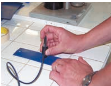
Contrôle de l'épaisseur du thermolaquage
